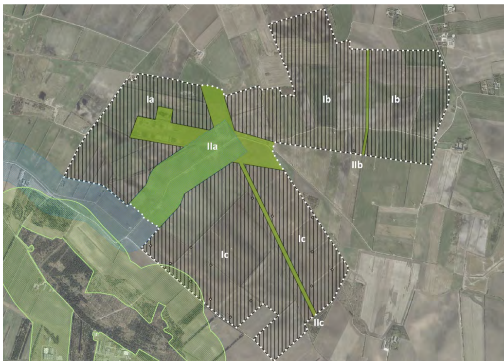
Kort 6.3: Åbeskyttelseslinje der opdeler områderne inden for lokalplanens grænse. De grå skraverede felter er områder til solcelleanlæg, mens de grønne er ubebygget faunapassage. Den blå skravering er åbeskyttelseslinje og den grønne skravering er skovbyggelinje.
